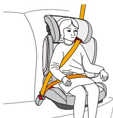
Au niveau de la boucle, séparez la partie diagonale et abdominale de la ceinture. La ceinture abdominale doit se trouver sous l'accoudoir dans le guide rouge situé sous l'accoudoir. La ceinture diagonale doit se trouver au-dessus de l'accoudoir.
