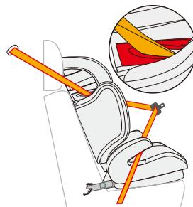
Ook als het kind niet in het autostoeltje zit moet het met een driepuntsveiligheidsgordel zijn bevestigd. with the 3-point-belt.
