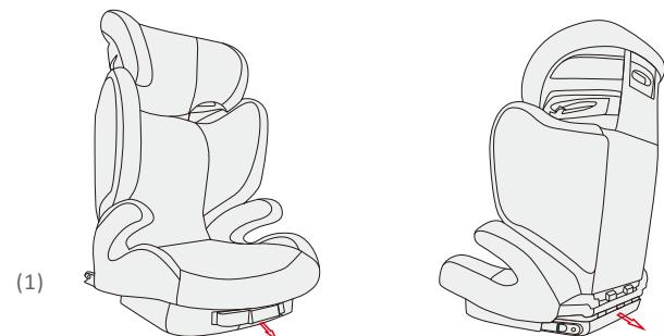
Um zu entriegeln (1) ziehen Sie und gleichzeitig ziehen Sie den Rastarmschutz heraus (2).
