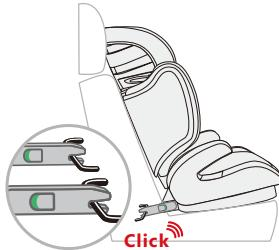
För att låsa stabiliseringssfästet, haka fast två låsarmar i kopplingar som finns i sätet.
