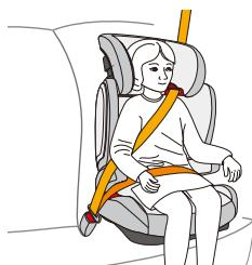
Auf der Seite des des Auto-Gurtschlusses legen Sie den Diagonalgurt und den Beckengurt. Der Beckengurt muss unter der Armlehne in der roten Gurtführung liegen. Der Diagonalgurt muss über der Armlehne liegen.
