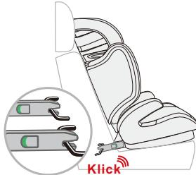
Per bloccare il fissaggio di bloccaggio, monta le due serrature sui collegamenti ubicati sul sedile. Assicurati di sentire un "click" (2x) e che compaiano due indicatori verdi.
