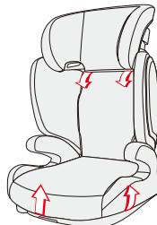
Ziehen Sie den Bezug aus der Rückenlehne und dem Grundgestell. Beginnen Sie mit den in der Abbildung mit Pfeilen gekennzeichneten Punkten.
