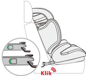
Pentru a bloca dispozitivul de stabilizare, montați brațele de fixare în punctele de fixare ale banchetei.
