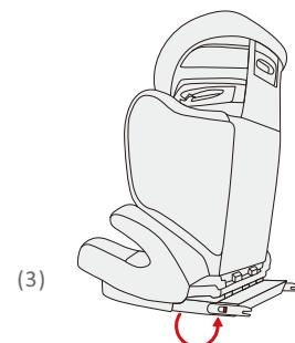
Drehen Sie die Verriegelungsarme in die richtige Richtung.
