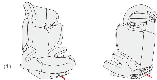
Pociągnij, aby odblokować (1) i jednocześnie pociągnij i wysuń złącze mocujące (2).
