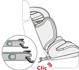
Afin d' installer le siège, fixez les deux pinces pour ancrage aux crochets qui se trouvent dans le siège du véhicule. Assurez-vous d'entendre distinctement deux (2x) clics et de voir apparaître deux voyants verts.
