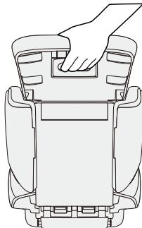
Fassen Sie die Rückseite der Kopfstütze und drücken Sie den Verstellgriff leicht nach oben
