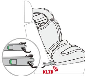
W celu zablokowania mocowania stabilizującego, zamontuj dwa ramiona zatrząskowe na złączach znajdujących się w siedzisku. Upewnij się, że usłyszysz wyraźny dźwięk „klik”(2x) oraz że pojawią się zielone znaczniki.
