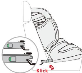
Um die Verriegelungsbefestigung des Sicherungssystems zu verriegeln, klemmen Sie die zwei Einschiebeführungen auf die zwei Befestigungspunkte, die im Sitz Ihres Fahrzeuges zu finden sind. Vergewissern Sie sich, dass Sie ein deutliches „Klick“ (2x) hören und dass die grünen Sicherungsknöpfen auf beiden Seiten sichtbar sind.
