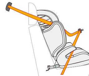
Entfernen Sie den Sicherheitsgurt aus den Gurtführungen.
