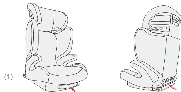
Tirez pour débloquer (1) et en même temps tirez et sortez le raccord de fixation (2).
