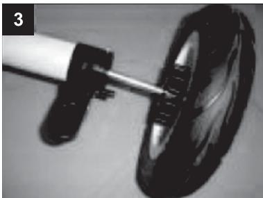
Промушете осите на всяко едно от задните колела в съответните отвори от тръбата в задната част на рамата на триколката (фиг. 3). Монтирайте с натиск, докато чуете щракване и колелата се фиксираят.
