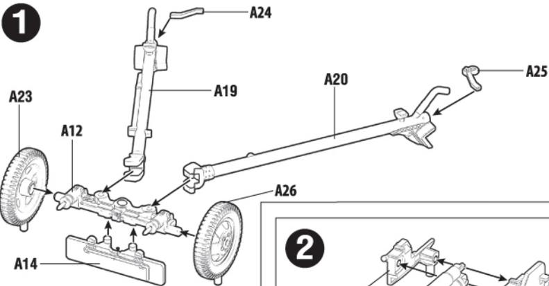
Детали 24 и 25 устанавливаются при помощи специального клея, выпускаемого предприятием «Звезда»
