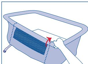
2) Deslizar o botão de uma extremidade da barra extraível e extraí-la parcialmente. Posteriormente, proceder da mesma maneira no outro lado de forma que possa retirar completamente a barra extraível.
