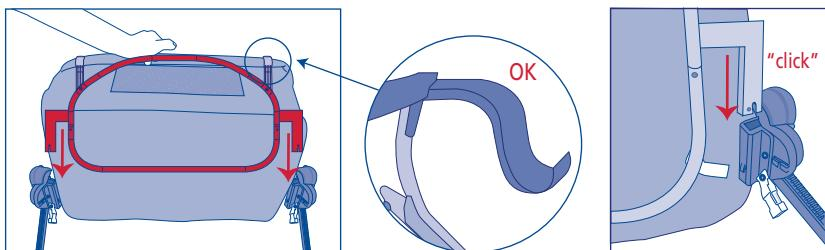
Щоб укріпити матрац на нижній рамі, потрібно після складання ліжка зафіксувати його застібками «велкро» (4), розташованими в нижній частині текстильного покриття на трубці рами.
