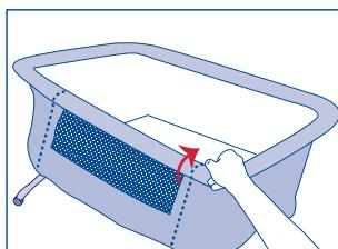
2) 移开可取下护栏一边的按钮，将其部分卸下。然后用同样的方法操作另一边，将其完全取下。
