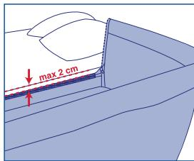
**-ΠΡΟΕΙΔΟΠΟΙΗΣΗ:** Χρησιμοποιείτε την κούνια με την αποσπώμενη ράβδο κατεβασμένη μόνο όταν χρησιμοποιείται ως κούνια συν-κοίμησης.
