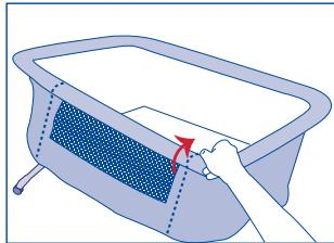
2) Schieben Sie den Druckknopf von einem Ende der abnehmbaren Stange und ziehen Sie sie teilweise heraus. Anschließend gehen Sie auf der anderen Seite auf die gleiche Weise vor, damit Sie die abnehmbare Stange komplett herausziehen können.
