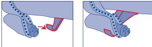
4) Breng de wieg bij het bed van de ouders en controleer de hoogte van de wieg ten opzichte van het bed van de ouders. Om het bijzetwiegje aan het volwassenenbed te bevestigen wordt gebruik gemaakt van de twee extra riemen die bij de wieg worden geleverd.
