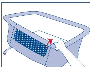
2) Deslizar el pulsador de un extremo de la barra extraíble y extraerla parcialmente. Posteriormente, proceder de la misma manera en el otro lado de manera que pueda retirar la barra extraíble completamente.
