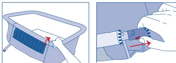
c) Rozepněte suché zipy na postranních částech potahu, které jsou připnuty ke svislým profilům.
