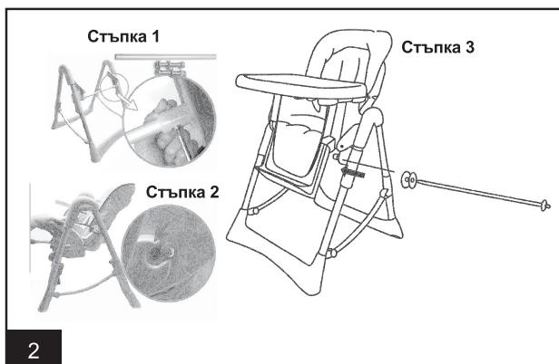
**Стъпка 1:** Монтирайте оста между предните и задните тръби. Фиксирайте с винт, две шайби и гайки от двете страни.
