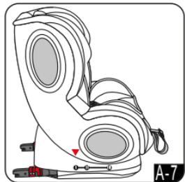
**WARNUNG!** Dieses System ist mittels eines Federsystems unter einer Druckspannung. Stehen Sie nicht hinter dem Sitz, während Sie die Längenverstellung (14) bedienen! Der Bereich von 30 cm hinter dem Sitz muss frei sein. Bitte entfernen Sie alle sich dort befindlichen Gegenstände.
