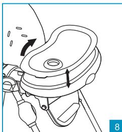
Pentru a inlatura tavita din interior (8) trage clipsurile din lateral si ridica tavita. Tavita din interior este fixata pe tavita principala folosind un mecanism de presare. Pentru a atasa tavita interioara, pune-o deasupra tavitei principale si apas-o in jos. Clipsurile de siguranta vor bloca tavita interioara in tavita principala.
