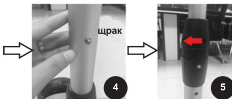
**ЗАБЕЛЕЖКА:** При фиксиране на всяка позиция трябва да чуете звук „щрак“ и щифта да попадне в съответния отвор.
