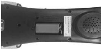
Отстранете капачето на гнездото за батерии. Поставете батерията (литиево-ионна 3,7V/4000mAh), като спазвате означения поляритет. Поставете капачето и фиксирайте с винт.
