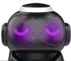
Las cinco luces LED (diodo emisor de luz, por sus siglas en inglés) pueden programarse para brillar con distintos colores
