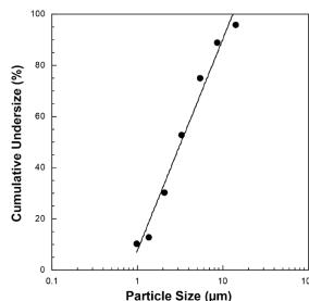
Ölçümler "Next Generation Impactor" (NGI) özellikli bir sodyum florür çözeltisi ile gerçekleştiriliyor. Grafik bu nedenle süspansiyonlar veya çok koyu kıvamlı ilaçlar için geçerli olmayabilir. Bununla ilgili ayrıntılı bilgileri ilgili ilaç üreticisinden alabilirsiniz.
