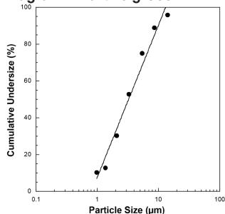
Die Messungen wurden mit einer Natrium-Fluorid-Lösung mit einem "Next Generation Impactor" (NGI) durchgeführt. Das Diagramm ist möglicherweise so nicht auf Suspensionen oder sehr zähflüssige Medikamente anwendbar. Nähere Informationen dazu können Sie vom jeweiligen Medikamentenhersteller erfahren.
