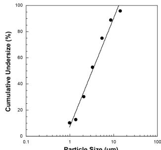
Измерения производились с использованием раствора фторида натрия при помощи импактора нового поколения (Next Generation Impactor = NGI). Поэтому диаграмма может не подходить для суспензий или очень густых медикаментов. Более подробную информацию можно узнать у производителя соответствующего лекарства.
