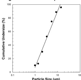
Las mediciones se realizan con una solución de fluoruro sódico con un "Next Generation Impactor" (NGI). Así pues, el diagrama puede no ser aplicable a suspensiones o medicamentos altamente viscosos. Puede obtener más información del fabricante de la medicación.
